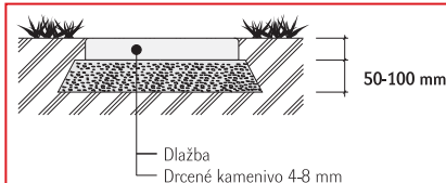
Obr. č. 2: Uložení do konstrukce
